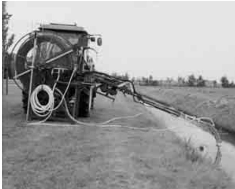
Fig. 6.5 Een drainreiniger kan vanuit de trekkercabine door één persoon bediend worden.
