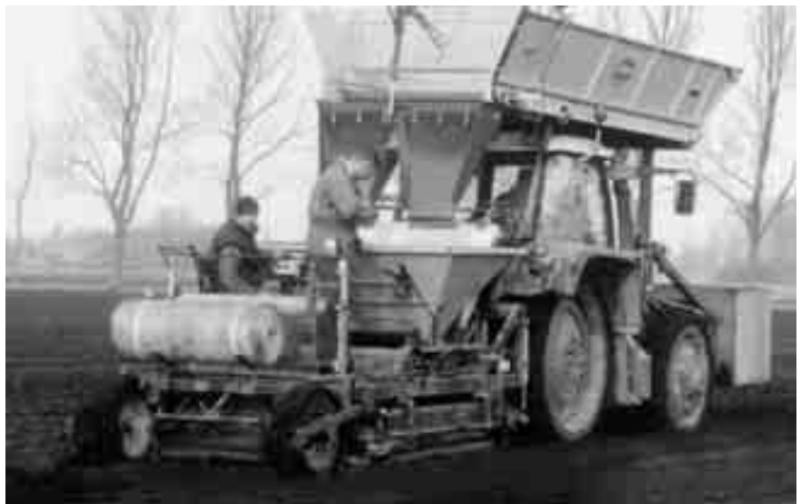
Fig. 2.9 Een bollenplanter, een zogenaamde nettenplanter, voor tulpenbollen
