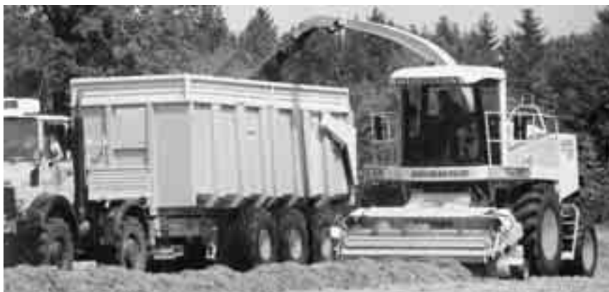
Fig. 12.3 Met een ander voorzetstuk kun je de hakselaar als grashakselaar gebruiken.
