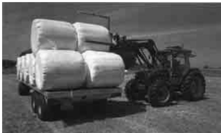
Fig. 11.13 Met een voorlader (met daaraan een balenklem ) worden de pakken van de oprolpers op de wagen gezet.
