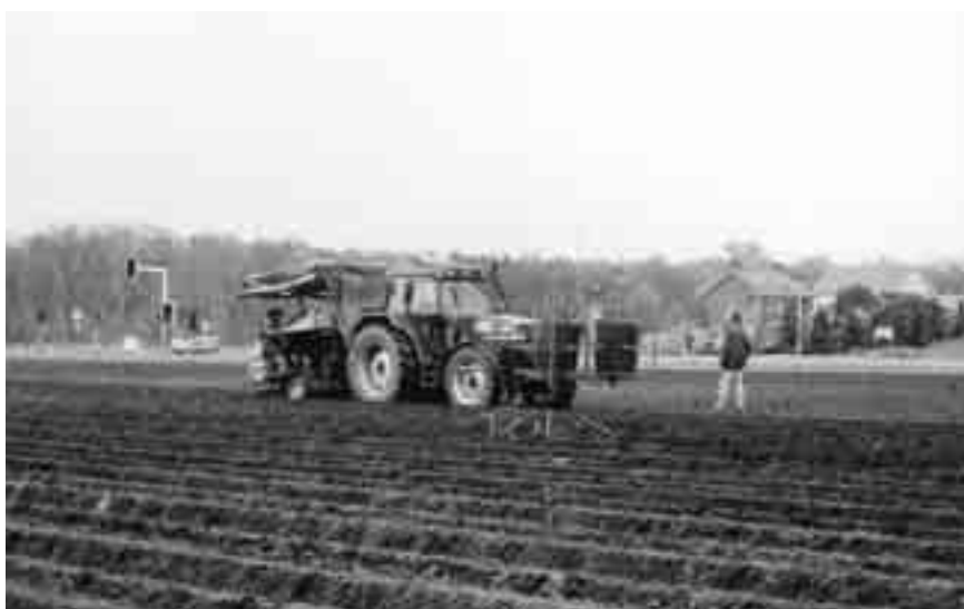
Fig. 3.4 Plantmachines voor asperges met slangen voor grondverwarming
