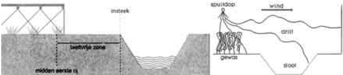
Fig. 4.9 De werking van een kantdop (links) en de gevolgen van drift bij een normale dop (rechts).
