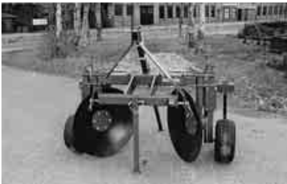
Fig. 4.43 Een beddenvormer met aanaardschijven (links) en een asperge-eg (rechts)
