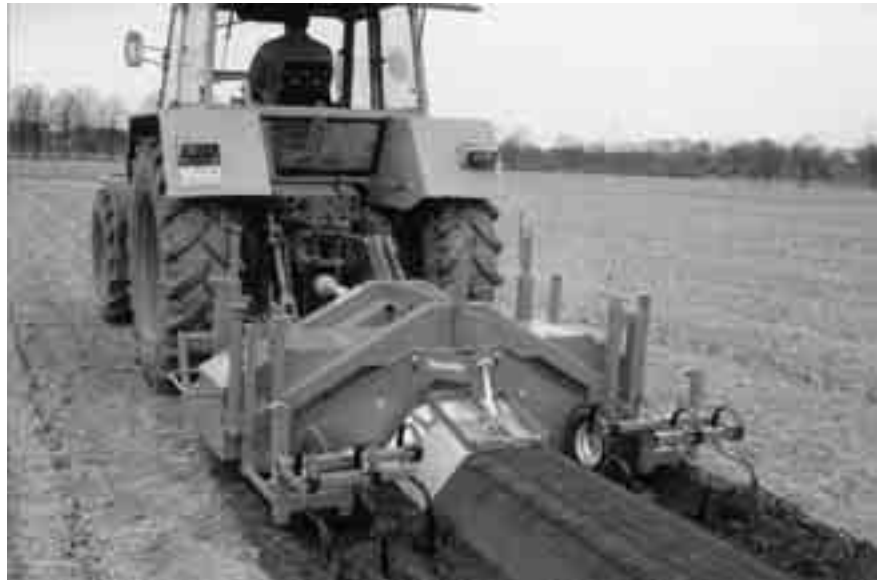
Fig. 4.42 Een aspergerijenfrees maakt een egaal gevormd bed.
