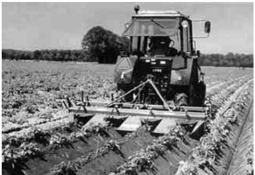
Fig. 4.38 Klepjes in de rugvormkappen dienen om na opkomst van het gewas te kunnen aanaarden.
