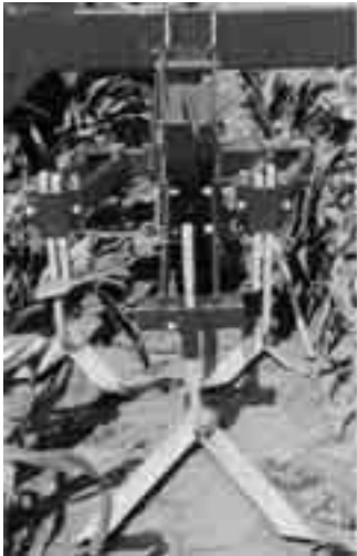
Fig. 4.20 Bij een stuurfout kunnen zelfsturende gewasgeleideschoffels naar buiten toe verschuiven.
