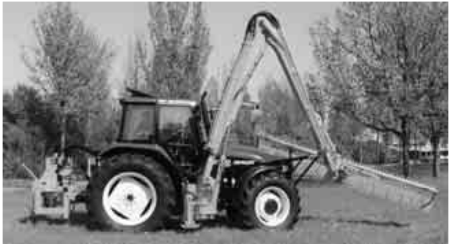
Fig. 6.8 Een trekker met een opgebouwd frame waaraan zich een knikarm met een maaikorf bevindt.
