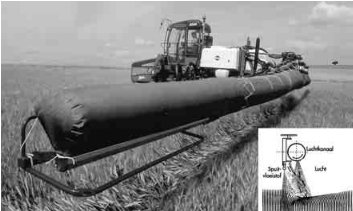
Fig. 4.8 Een zelfrijdende spuit met luchtondersteuning
