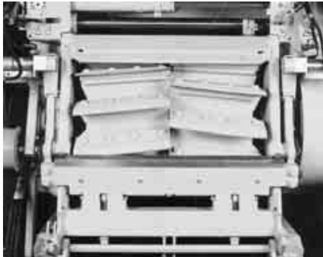
Fig. 12.5 Een messenkooi knipt het gewas in stukjes.
