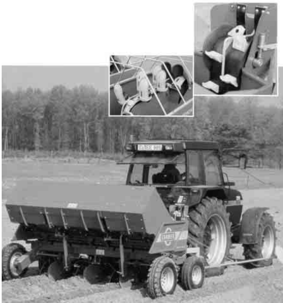
Fig. 2.3 De onderdelen van een aardappelpootmachine; het werktuig rechtsboven heeft bекers en het werktuig middenboven heeft lepels.
