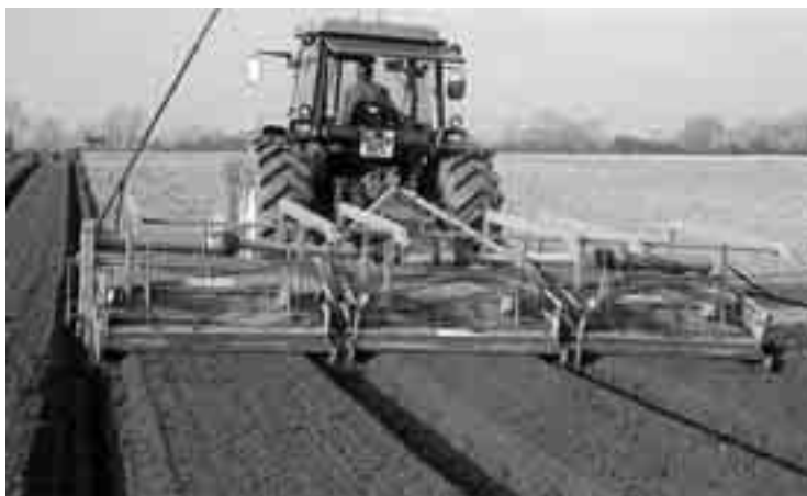
Fig. 4.40 Een hakenfrees met een speciale beddenvormer die drie bedden tegelijk kan maken
